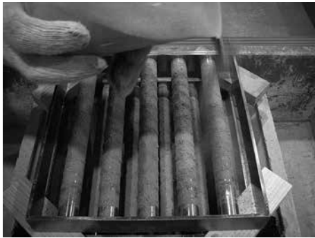
写真3 格子型マグネットによる磁力選別
