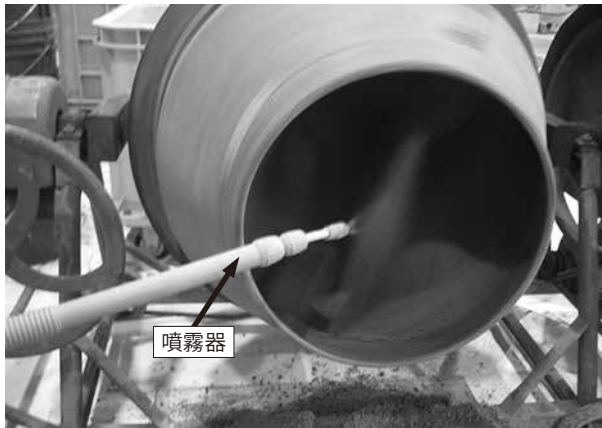
写真1 模擬セシウム汚染土壌の調製
