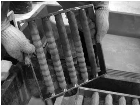
写真4 磁着した試料
