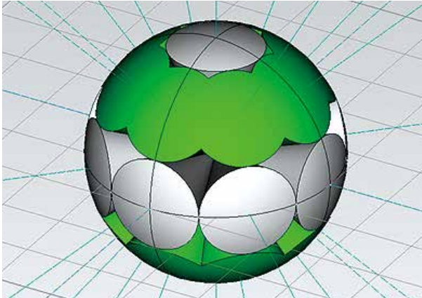
図4 全方位指向性モニタリングのイメージ(球体中央が測定点)
