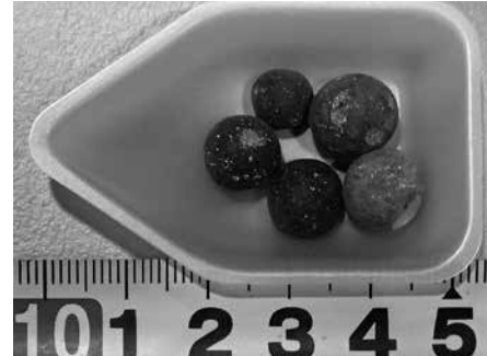
写真2 1450℃で得られたセメントクリンカの外観
