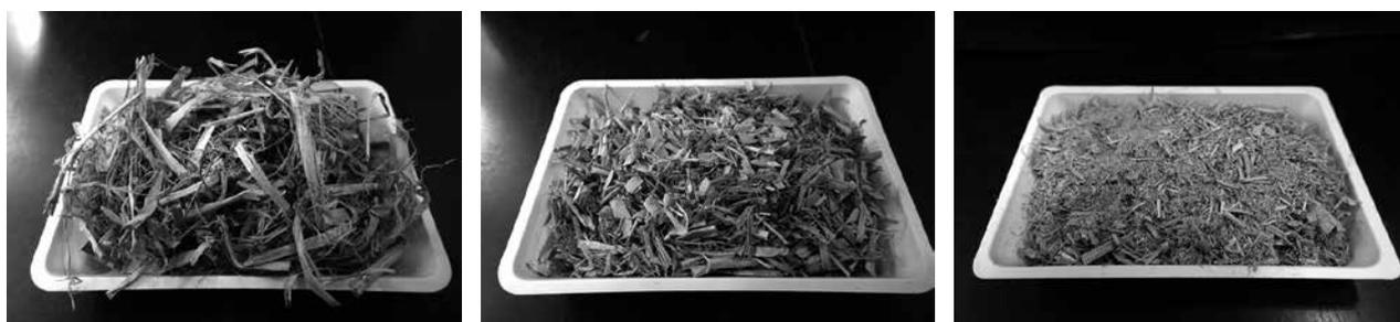
写真3 粉碎度別の試料(容器サイズ:100×70×13 mm)
