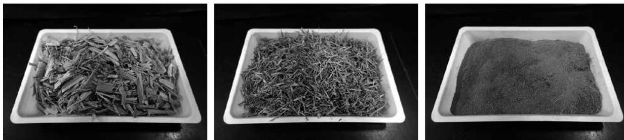
写真2 ふるい分け後の粒径別の試料(容器サイズ:100×70×13 mm)
