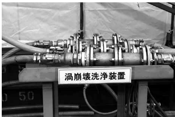
図14 磨砕(渦崩壊)洗浄装置
