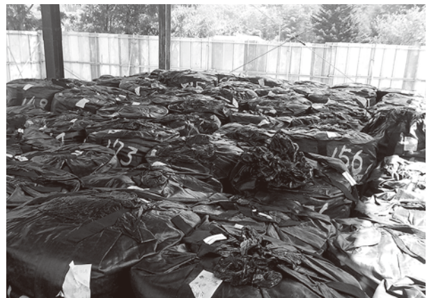
図2 処理前の放射能汚染土(路面清掃土砂)
