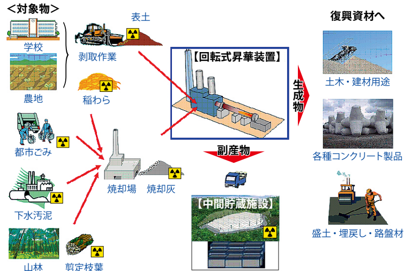
図3 乾式Cs処理技術の概要
