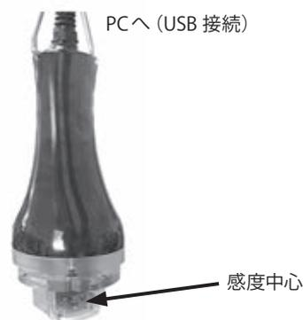
図2 簡易線量率計 PA-1100W 外観 (PA-1100 内蔵)
