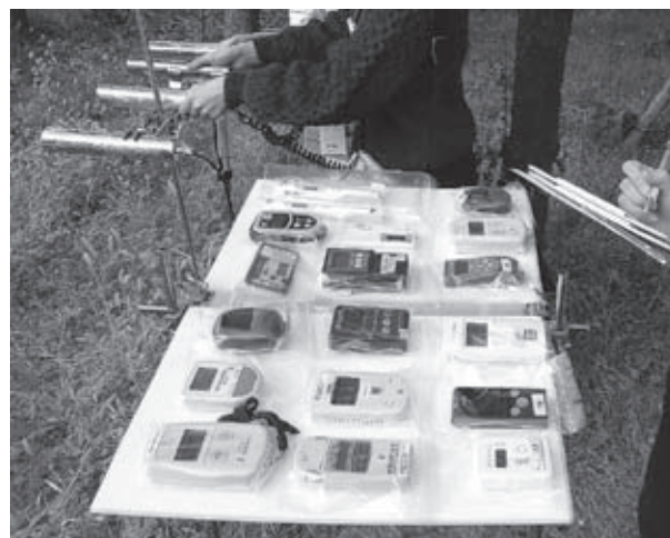
Fig.2 地上から1 mの高さの空間線量率の測定
