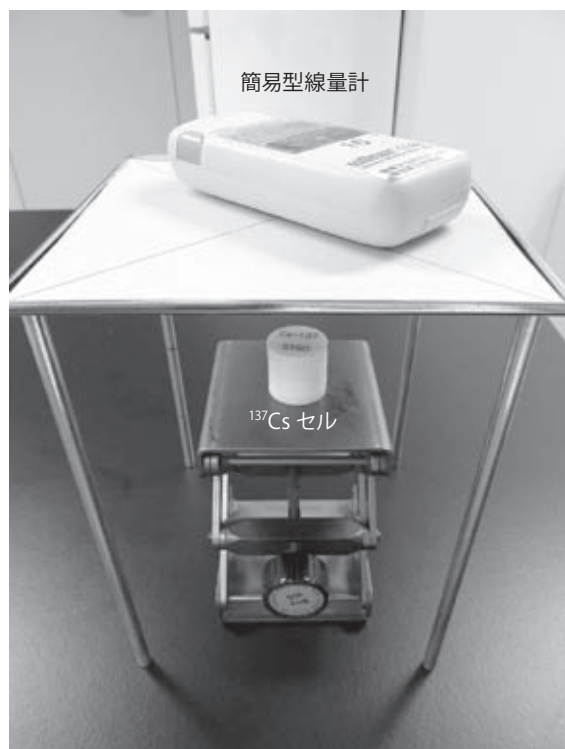
Fig.1 計数率及び 137 Cs線源の測定
