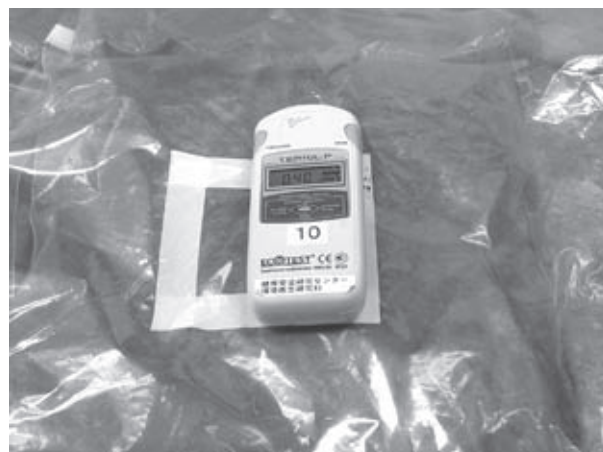
Fig.4 模擬汚染場所の測定
