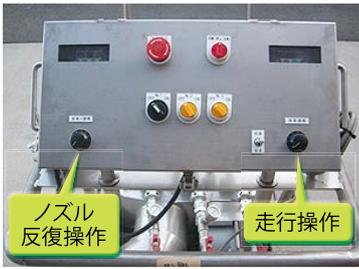
図 25 二系統の操作盤
