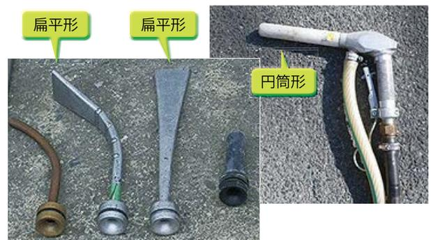
図8 吐出ノズルとブラストガン
