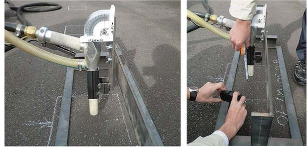
図11 吐出ノズルの角度及び離隔距離測定状況
