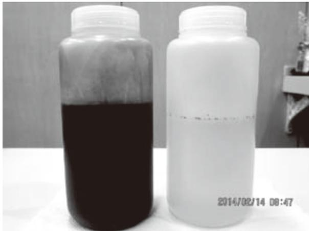
図2 処理後残渣と洗浄水の混合液(左) および洗浄水(右)
