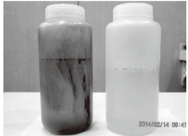
図3 図2の混合液を7000 rpmで100分間遠心分離した液(左) および洗浄水(右)
